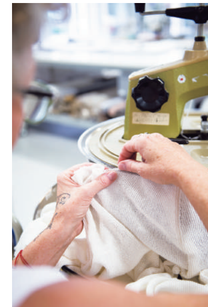
各種マシンが並ぶ縫製部門。様々な針幅を揃えた丸型編み機では、熟練の職人がニットの胴部や袖を合体させる。
