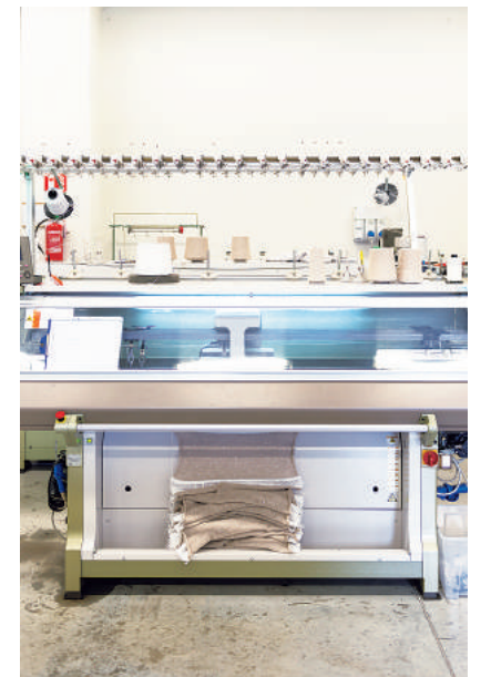
和歌山が世界に誇る島精機製作所のニットマシンでは、糸の無駄を出さず、縫製なしで一着を丸ごと編み上げる。
