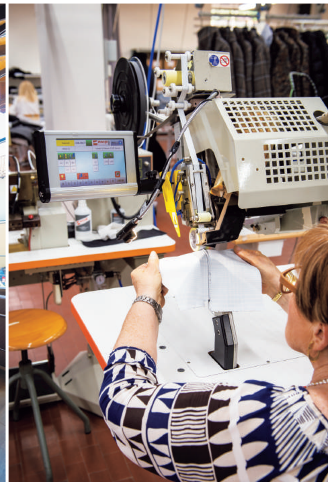
01 02 01: 本社の裏、美しい清流が水々の間を流れるエルノ川。02: 社内には社長の趣味である現代アートが至るところに飾られている。昨年改装されたエントランスの天井には韓国人アーティスト、リ・ゼ・ヒョウの作品が。03: ライブラリーのローテーブルの上にあるのは地元のアーティスト、ジャンニ・カラヴァッジョの作品。ローカルの才能も積極的に応援。04: 社内にある工場にて、熟処理でシームレスに生地を繋ぎ合わせる作業中。このディテールが耐寒効果を高める。
