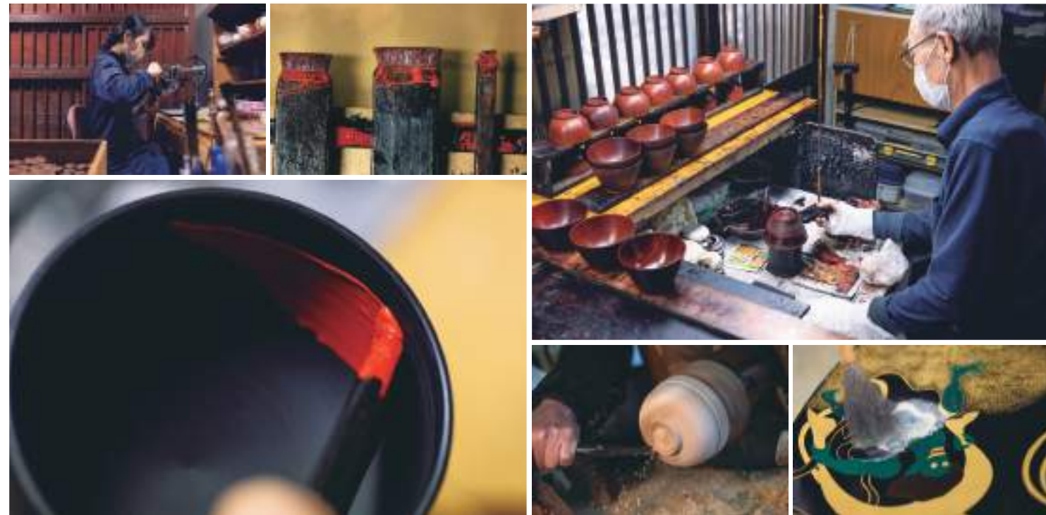
1 2 4 1. 山中では珍しく、上塗りを行う若い女性の塗師。2. 刷毛に使うのはしなやかな人毛。染色やトリートメントを行わない生の毛髪が良く、年々生産が減っている。 3 5 6 3. 黒地に朱の漆を塗る。この後、筆で均質にムラなく塗り重ねていく。4. こちらは下塗り工程にあたる摺漆。木地に漆を刷り込み、木の導管を目止めることで漏れをなくす。何度も工程を重ね、漆特有の奥行きある表情や色合いを出す。5. 山中は丸物と呼ばれる碗や鉢を得意とする産地。他に比べ、丸くくり抜いていくロクロ作業を得意とする。山中漆器は木地師の団体が定住し、木地を挽き始めたことに端を発する。温泉客に販売し、産地が成長した。6. 銀を塗る加飾作業風景。
