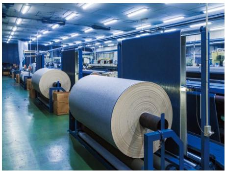
電子制御された高速回転のエアージェット織機。24時間稼働させることで、短納期にも対応する。ベーシックなコットンからリサイクルコットンや合織、テンセルといった幅広い糸を使い、新しい感覚のデニムを生み出すことに力を入れている。
