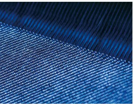
デニムは、藍で染色した経糸(縦糸)と未染色の緯糸(横糸)を綾織にしてできあがる布。近寄ることで、二種の糸で織られていることがわかる。使い込んだデニムは緯糸に加え、緯糸の白い芯部分が露出することで独自の表情を生み出している。
