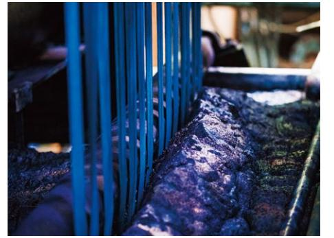
染色槽に浸かる糸。数十個の染色槽に浸けた糸を引き上げ、ふたたび染色槽に浸けて、藍色を濃くしていく。引き上げることで染色液に浸染した色が空気に触れて酸化し、色が定着する。この時間や槽に浸ける回数で複雑な色の濃淡を実現していく。
